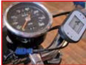
Verbinde den Stecker von kurvX mit dem Batterie-Anschlusskabel.
